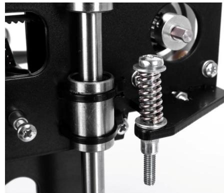
Проверяем зазор во всех 4х углах платформы. Платформа регулируется винтами M3
